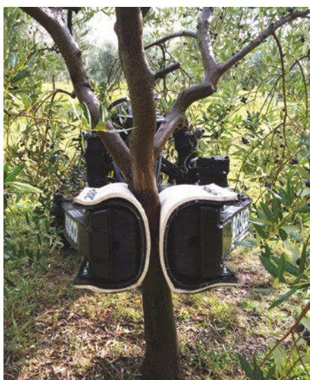
▲ La vibroscuotitrice Bosco Mac 104, montata su Robogreen, macchina polifunzionale radiocomandata che consente di lavorare su terreni impervi.
