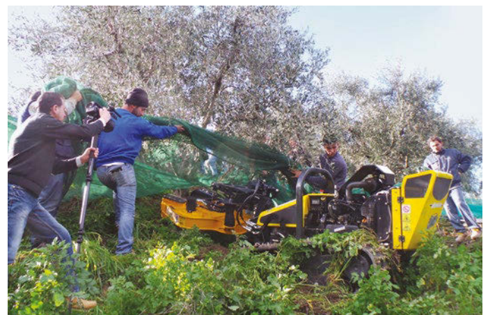
▲ RoboGreen con pinza vibroscuotitrice Bosco Mac 104 per diametro tronco di 30 cm.
