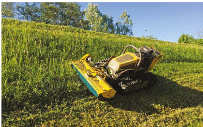
▲ RoboGreen equipaggiato di testata idraulica per trinciare residui di potatura, erbe e rovi lungo le scarpate.
