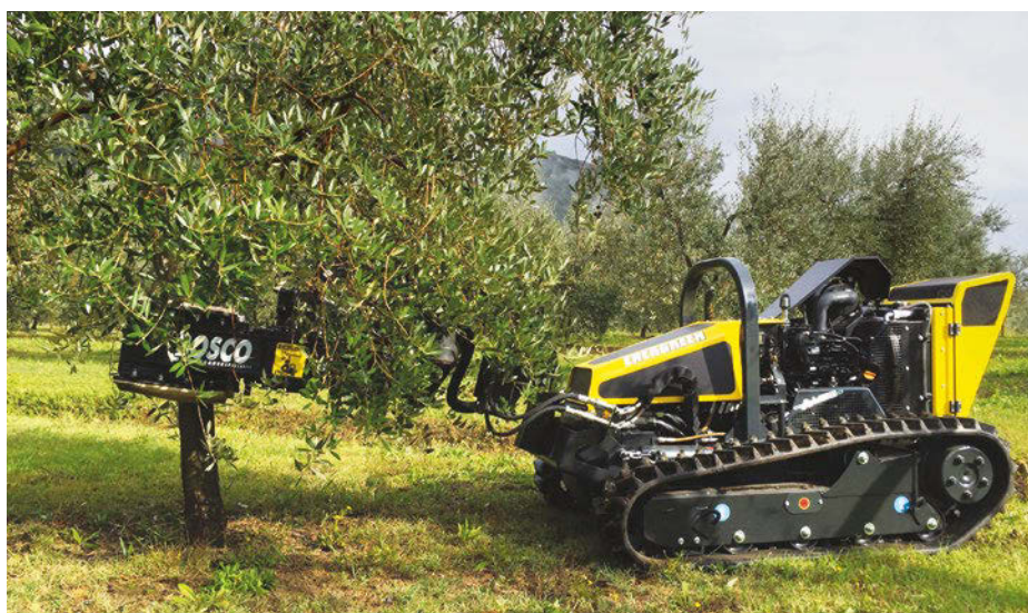
▲ La vibroscuotitrice Bosco Mac 104, montata su Robogreen, macchina polifunzionale radiocomandata che consente di lavorare su terreni impervi.
