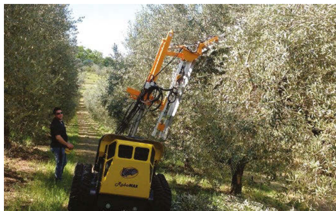
▲ RoboMax con barra potatrice Ero Binger pieghevole/telescopica dotata di 14 dischi.
