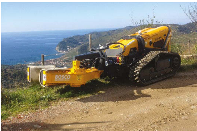
▲ RoboMax cingolato, equipaggiato con pinza vibroscuotitrice Bosco Mac 304 per diametro tronco di 50 cm.
